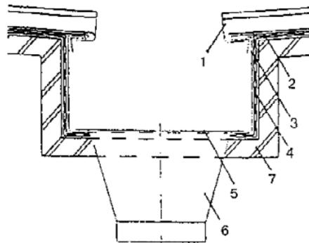
1 - стоячий фальц с квадратными кромками; 2 - карнизные планки; 3 - медная обделка желоба; 4 - подстилающий слой; 5 - медная решетка; 6 - воронкообразный водослив из кровельной меди; 7 - основание
