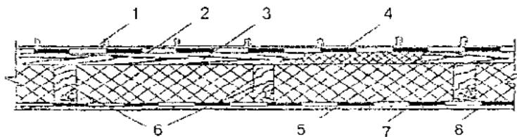
1 - фальцевая медная кровля; 2 - подстилающий слой; 3 - сплошной настил из досок хвойных пород; 4 и 5 - слои теплоизоляции; 6 - стропила; 7 - пароизоляция; в - потолок
