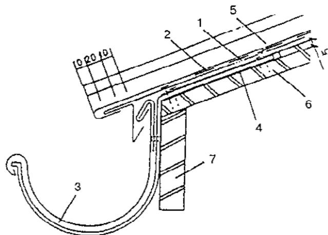
1 - карнизный свес; 2 - подстилающий слой; 3 - полукруглый водосточный желоб; 4 – кронштейн водосточного желоба; 5 - медная кровля; 6 - основание под кровлю; 7 - стена
