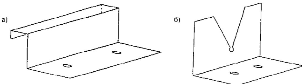
**Рисунок 5 - Неподвижные кляммеры, изготавливаемые механизированным (а) и ручным (б) способами**
