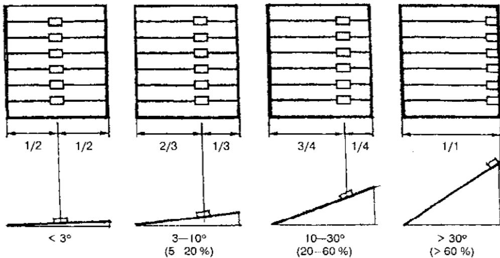
**Рисунок 8 - Места установки неподвижных кляммеров на кровле с длиной ската более 3 мм в зависимости от уклона**
