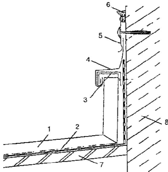
1 - медная фальцевая кровля; 2 - подстилающий слой; 3 - медный кронштейн; 4 - медный фартук водослива; 5 - медный фасонный элемент; 6 - герметизирующая мастика; 7 - основание под кровлю; 8 - стена
