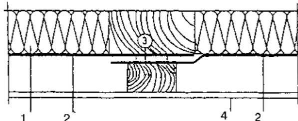
1 - теплоизоляция; 2 - пароизоляция; 3 - герметизирующая полоса; 4 - потолок (например, гипсокартон)
